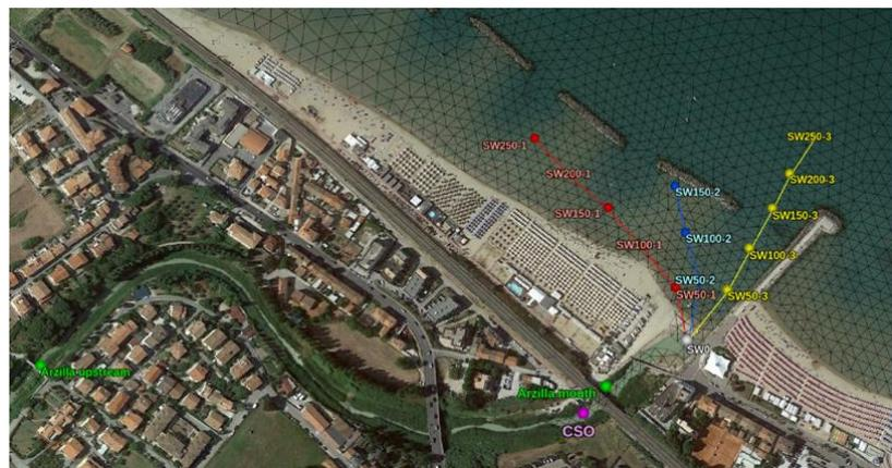
**Figura 6.3 - 2** Griglia di campionamento in mare di fronte alla foce del fiume Arzilla. Le stazioni di campionamento distribuite lungo tre transetti (transetto 1 in rosso, transetto 2 in blu, transetto 3 in giallo) sono posizionate a distanza incrementale dalla costa con differenti punti di prelievo: a 50 m, 100 m, 150 m, 200 m, 250 m dalla foce.
