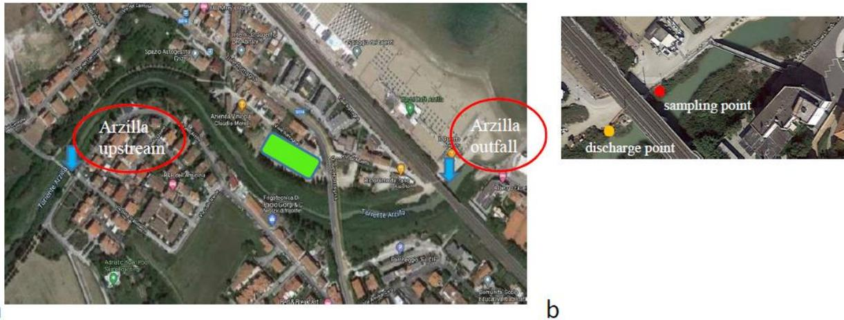
**Figura 6.3 - 1** Sito di studio e strategia di campionamento; a) posizionamento di due stazioni di campionamento lungo il fiume Arzilla, foce Arzilla (dove è localizzato il campionatore automatico delle acque per analisi microbiologiche e chimiche) e Arzilla monte; b) punto di scarico o CSO (deflusso fognario combinato) e la stazione di campionamento automatico.
